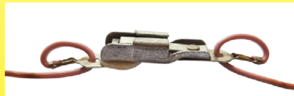
Ограничитель температуры нагревательного одеяла Calor с медленным разрывом, откалиброванный на 80°C (около 1960 г.). Обратите внимание на водонепроницаемую PVC втулку, приваренную к проводам, и петлю, сделанную электрическими проводами, проходящими через отверстие в каждой клемме - это сделано для устранения растягивающих напряжений на проводах (коллекция Ultimheat)
