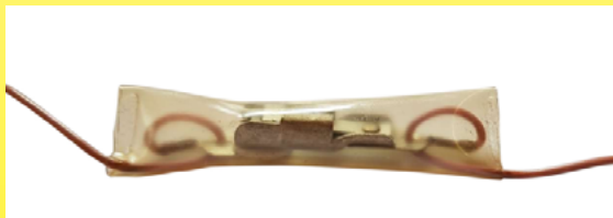
Ограничитель температуры нагревательного одеяла Calor с медленным разрывом, откалиброванный на 80°C (около 1960 г.). Обратите внимание на водонепроницаемую PVC втулку, приваренную к проводам, и петлю, сделанную электрическими проводами, проходящими через отверстие в каждой клемме - это сделано для устранения растягивающих напряжений на проводах (коллекция Ultimheat)
