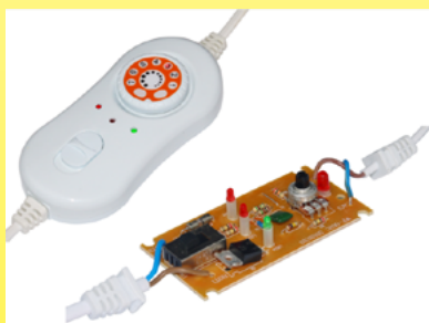
2019 Блок управления одеялом с непрерывным электронным управлением мощностью (коллекция Ultimheat)
