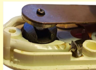
1972 г. Блок управления мощностью, изготовленный компанией Jidé в Лиможе под маркой Jidéstat. Самая успешная из всех систем. Очень маленькая по размеру, она регулируется и встроена в электрическую вилку. Это единственная модель с защелкивающимся магнитным контактом. Она не была превзойдена электромеханическими системами вплоть до нынешней эпохи. (Коллекция Ultimheat)
