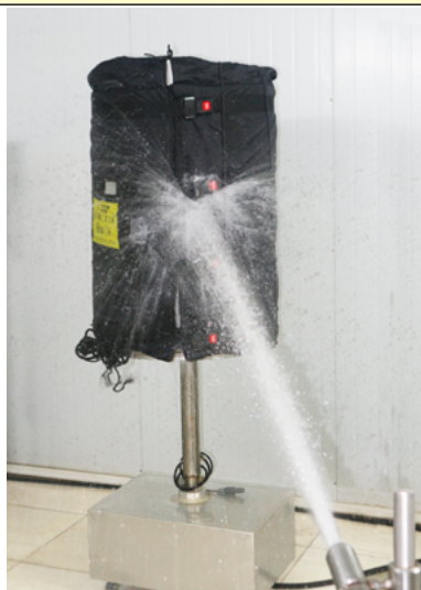
Испытание нагревателей рубашки на степень защиты IPx6
