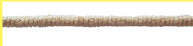
1960 г. Нагревательный шнур Calor, диаметр 1,7 мм, одинарный никель-хромовый нагревательный провод, диаметр 0,08 мм, на слегка скрученном хлопковом сердечнике для предотвращения смятия (коллекция Ultimheat)
