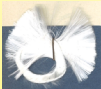
Пучки нитей стеклянной нити, образующие единый провод (Производство стеклянной нити, около 1960 года, урок в текстильной школе Вербье в Бельгии, музей Ultimheat)
