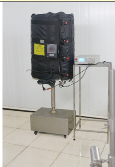
Измерение сопротивления изоляции после испытаний IPx6
