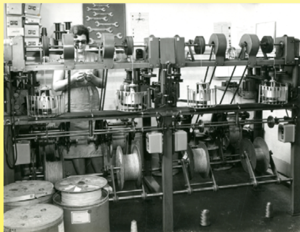
1960 г. Мастерская по изготовлению гипажей для нагревательных шнуров, используемых в электрических одеялах (Музей Ultimheat)
