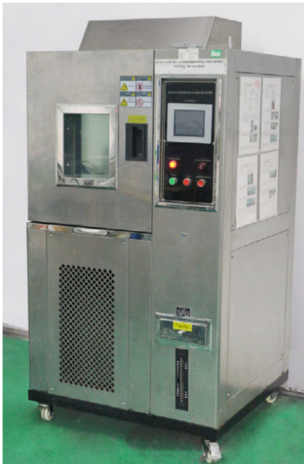
Климатическая камера, с диапазоном регулировки температуры от -90 до + 150°C, диапазон регулировки относительной влажности от 1 до 100%
